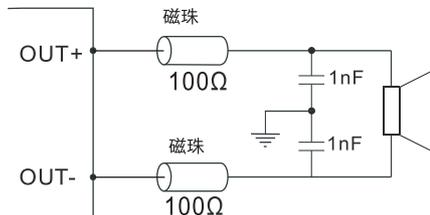
如果放大器应用于对噪声要求比较苛刻的系统中,输出可以考虑串接LC滤波器。滤波器的相关参数如下图所示:
