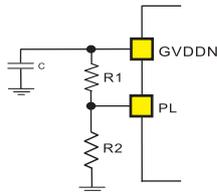
CS8316C的功率限制功能是通过PL引脚电压的设置实现的,通过GVDDN对地电阻分压可选择合适的输出限制功率。
