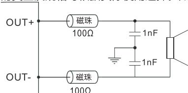
如果放大器应用于对噪声要求比较苛刻的系统中,输出可以考虑串接LC滤波器。滤波器的相关参数如下图示:
